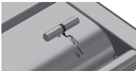
Obrázek 8: V ručním režimu musí být víko v uzamčené poloze.
