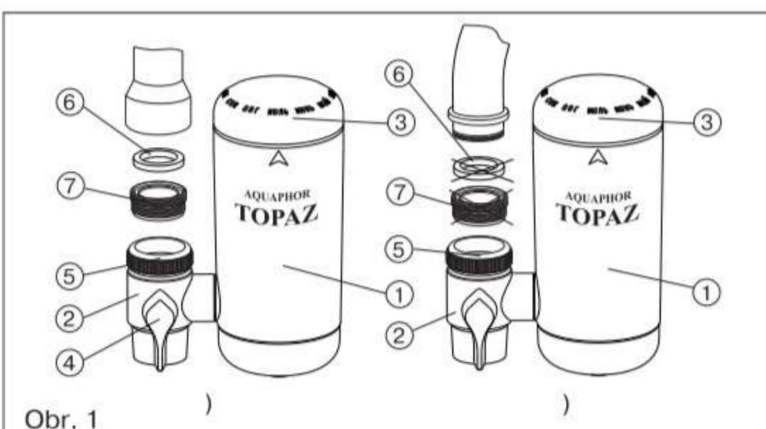
**Pozor!** Během připojení čističe vody k vodovodní baterii se nesmí používat žádné náradí ani nadměrná síla.
