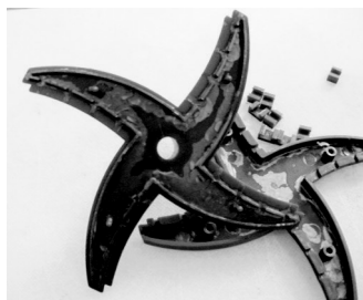
Rozložená hlava postřikovače připravená na pravidelnou údržbu. Film a povlak ze slupek semen může ucpat drobné otvory pro vodu.
